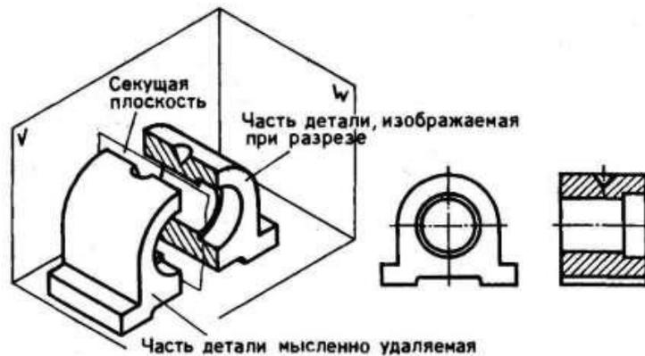
Рис.103. Профильный разрез.
