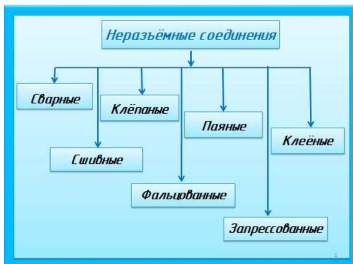
Рис. 114. Основные виды неразъёмных соединений
